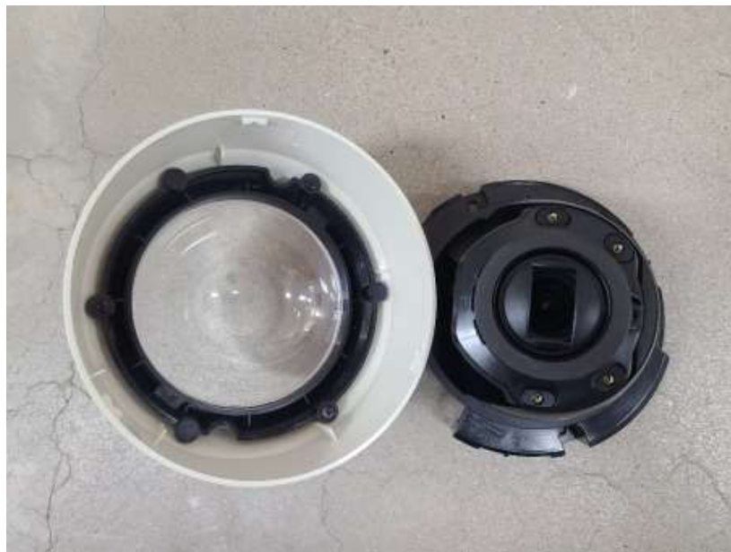
< 사진 2. IP5X 시험 후 내부 >
