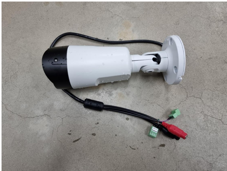
< 사진5. IPX7 시험 후 >
