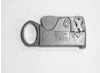
(그림 II-3) 동축케이블 스트리퍼
