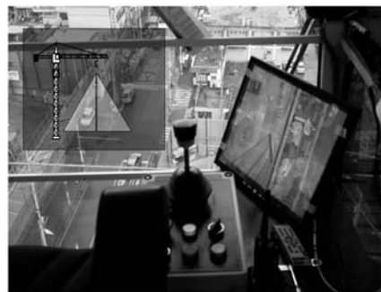
(그림 V-19) 타워크레인용 CCTV 설치사진
