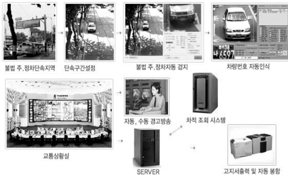
(그림 V-8) 불법 주·정차단속시스템 구성도
