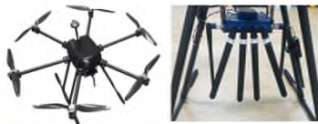
① 통신품질 측정 드론 개조 및 임무 설계
