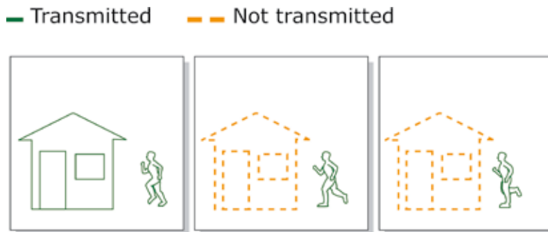
Figure 4. 차등 코딩(H.264를 비롯한 대부분의 비디오 압축 표준에 사용됨)을 사용하면 첫 번째 이미지(I-프레임)만 온전하게 부호화됩니다. 다음 이미지 (P-프레임)에서는, 정적 요소(즉, 집)에 대해 첫 번째 그림에 대한 참조가 이루어지고, 움직이는 부분, 즉 달리는 사람은 모션 벡터를 사용하여 부호화되기 때문에 전송되고 저장되는 정보량이 줄어듭니다
