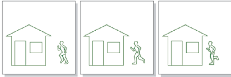
Figure 3. Motion JPEG 포맷을 사용하면 위의 순서에서 3개 이미지들은 서로 종속성을 갖지 않는 별도의 고유 이미지(I-프레임)으로 부호화되어 전송됩니다.
