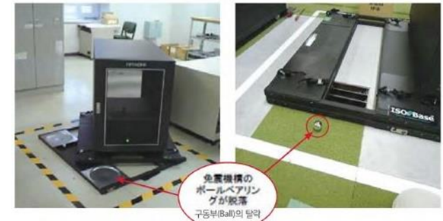
写真 3-8-2 <参考> 茨城支店等で機器免震装置の被災状況 사진 3-8-2 (참고) 이바라키 지점 등으로 기기 면진 장치의 피해 상황
